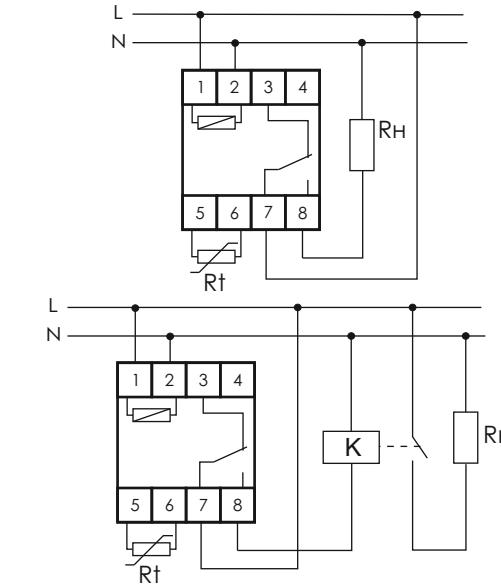
Схема подключения с применением контактора
